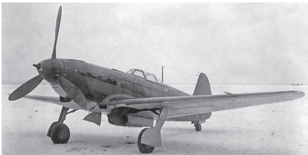
Истребитель Як-9Т с мощной пушкой НС-37 калибра 37 мм, 1943 г.
