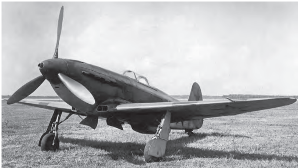
Модифицированный истребитель Як-1М, ставший прототипом Як-3, 1943 г.
