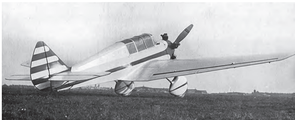
Двухместный спортивный самолет АИР-9 с мотором М-11, 1934 г.
