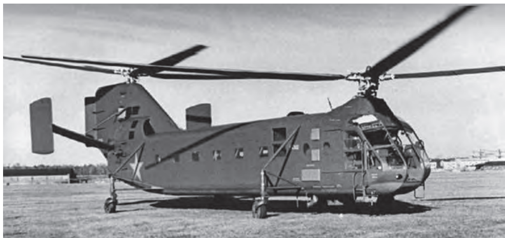
Транспортный вертолет продольной схемы Як-24 с двумя двигателями АШ-82В, 1952 г.
