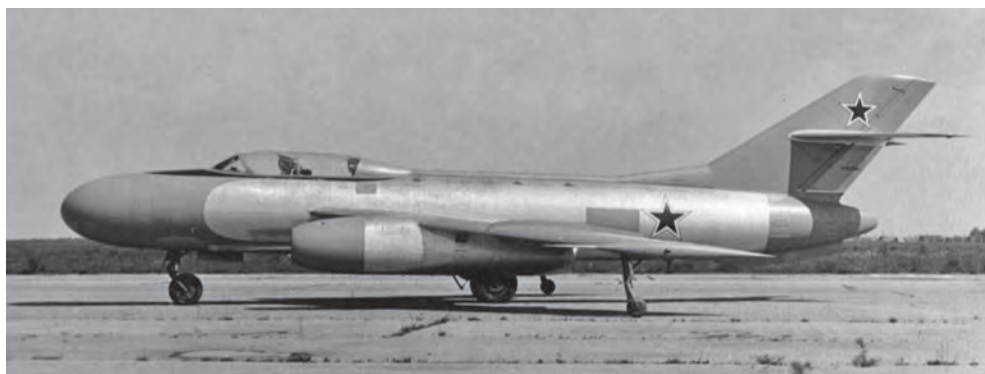
Всепогодный истребитель-перехватчик Як-25 с двумя двигателями АМ-5, 1952 г.
